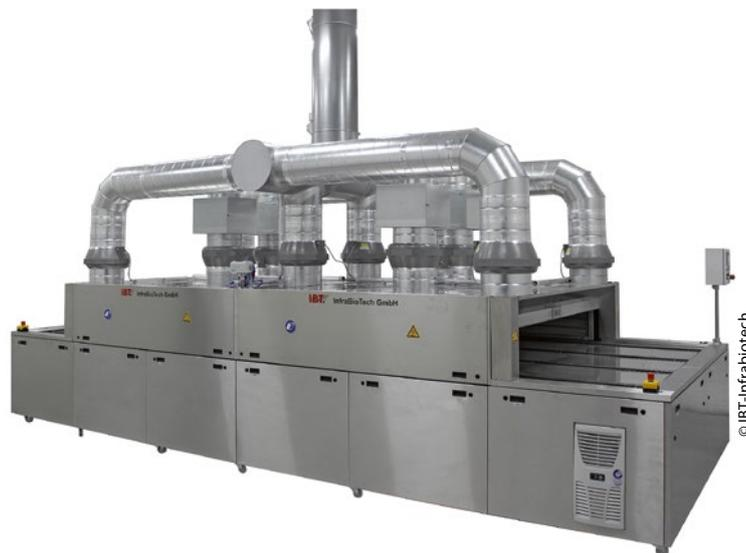
**Bild 5** > Der neue Lacktrocknungstunnel mit Abluftsystem vereint die Prozesssicherheit der elektrischen Infrarottrocknung mit dem EX-Schutz.
