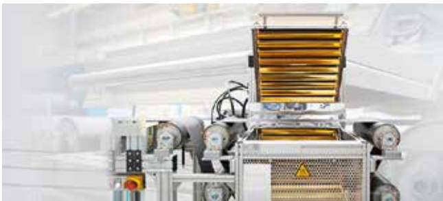
Bild 4. Erwärmung einer beidseitig grafitbeschichteten Kupferfolie mittels mittelwelligem Infrarot STIR (© IBT)
