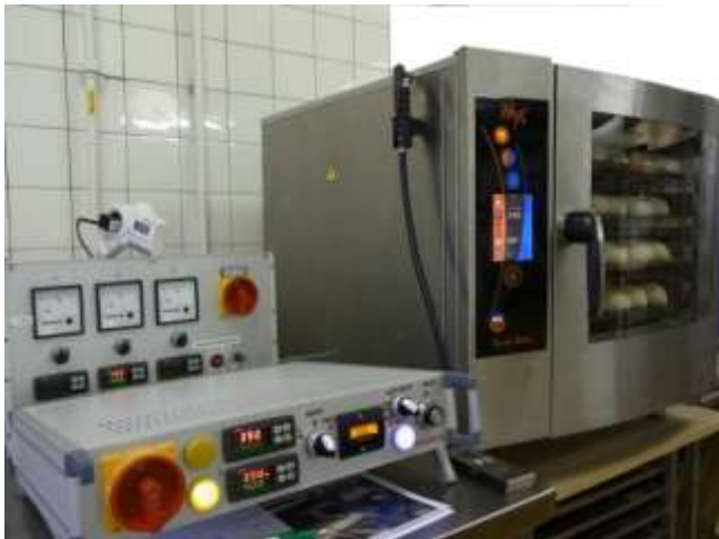
Bild 5: Versuchsstand mit Experimental-Hybridbackofen und Steuerungen für die Emitter
