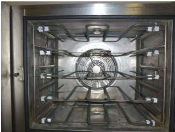
Bild 4: Backraum mit Emittlern umgerüstet
